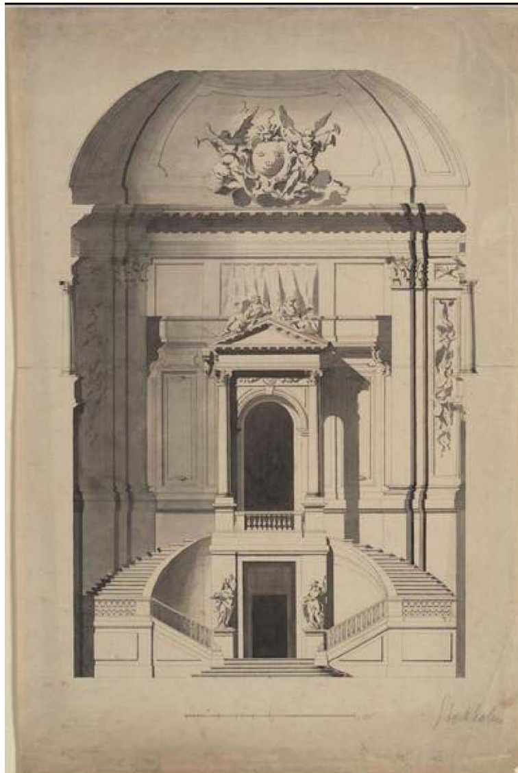
Abb. 8 S.L. Du Ry, Stockholm, Schloß, Bauaufnahme des südlichen Vestibüls, Schnitt (MHK, GS, LGS 13834)
